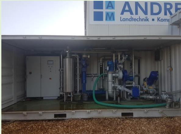
Die massive Zerkleinerung ermöglicht eine effiziente Nachbehandlung der Gärgülle bis zu einleitfähigem Abwasser
